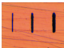
Рис. 4. Царапины на поверхности образца из закаленной стали с антифрикционным
